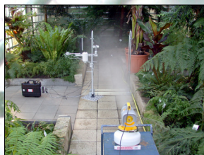
Abb. 4: Messstand mit Kaltluft-Nebelgerät im Vordergrund und Einspannvorrichtung für Pflanzen im Hintergrund; seitlich stehen die meteorologischen Messgeräte mit Datenlogger
